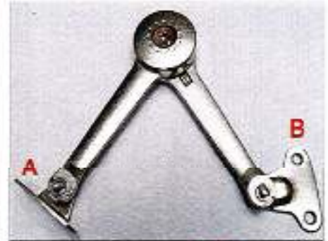
Trocar as peças A e B para alterar de aplicação à direita para esquerda
